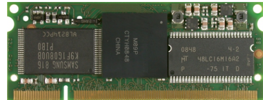
TRITON-TX25 ARM9 Module Shown Actual Size
